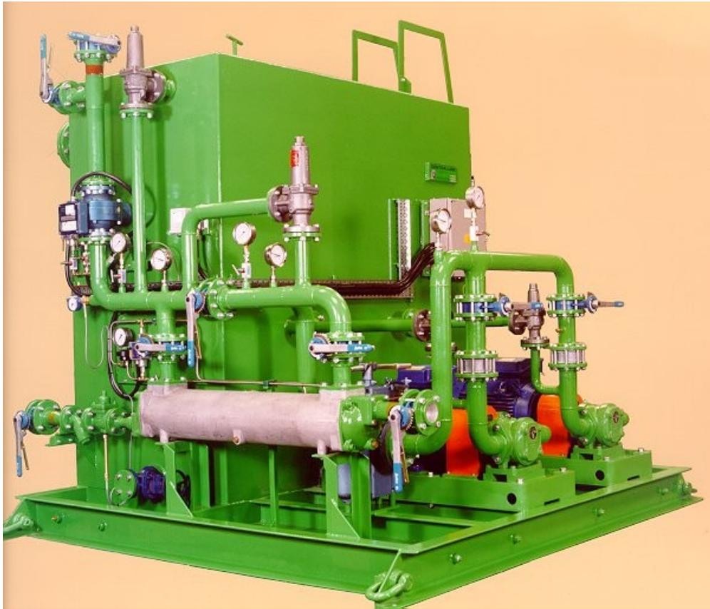
Системы циркуляционной смазки используются для подачи масла в подшипники или в зубчатые передачи не только для смазки, но и для защиты от загрязнения и, при необходимости, для отвода тепла, накапливаемого в масле за счет потерь энергии в узлах трения.
