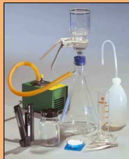
Комплект для вакуумной фильтрации с электрическим вакуумным насосом для подготовки мембранных проб для:
