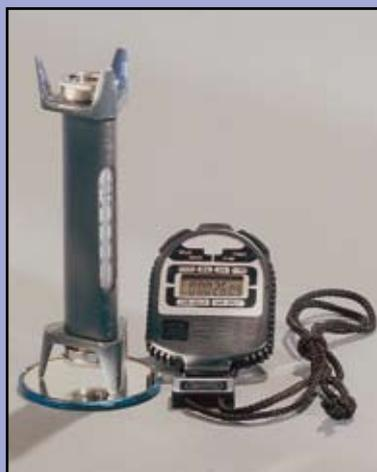
Измерительная труба с встроенным термометром, 3 измерительных шара, зеркало и электронный секундомер
