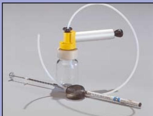
Вакуумный насос, шланги и телескопический стержень для статического отбора проб из ёмкости или резервуаров
