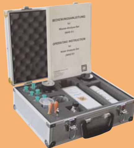
Набор для анализа воды WAS 01 для определения содержания воды в минеральных маслах согласно методу гидрид кальция
