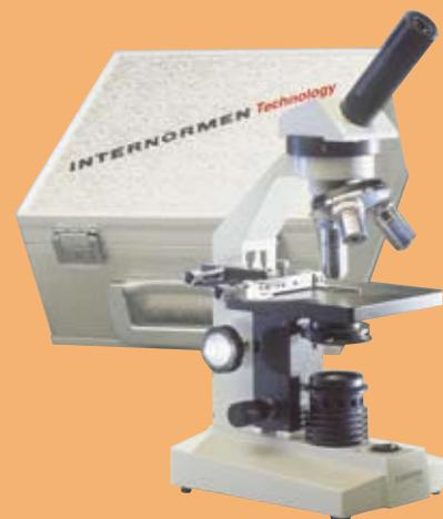
Микроскоп с окулярмикрометром, 3 объектива (40, 100, 400 x кратным увеличением), устройство проходящего луча и крестовый стол для микроскопического подсчёта частиц
