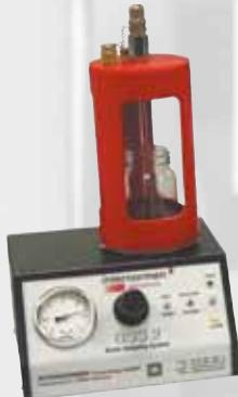
TSS 1 - устройство для изъятия проб из бака или резервуара
