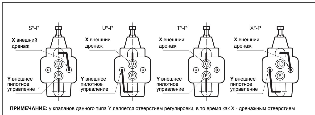
ПРИМЕЧАНИЕ: у клапанов данного типа Y является отверстием регулировки, в то время как X - дренажным отверстием
